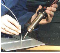
Şekil 38-29. Plastiklerin sıcak gaz kaynağı
