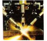
Üç üfleç yardımıyla X kaynak ağzının açılması
