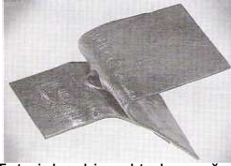
Şekil 38-6. Tatminkar bir nokta kaynağının sıyırma testi. Hasar, kaynağın dışında meydana gelmiştir
