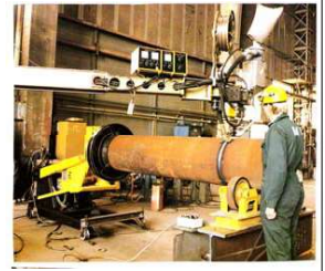
Fikstür yardımıyla büyük çaplı boru kaynağı
