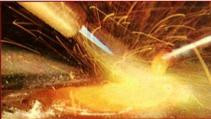
Oksijeni fazla (oksitleyici) alev, erimiş kaynak banyosunun üzerinde bir köpük oluşturur ve daha fazla kıvılcım çıkarır.
