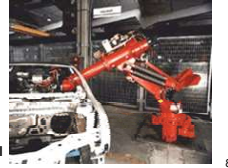
MIG/MAG kaynağının robotla uygulaması
