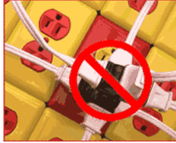
Şekil 19 Çoklu prizlere aşırı yükleme yangına neden olabilir.
