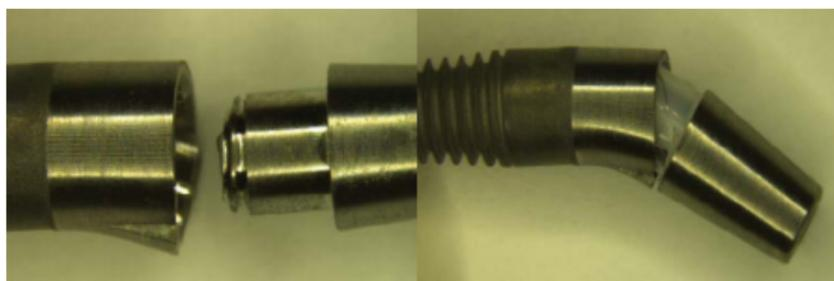
Fig. 16. Fracture dental implant.
