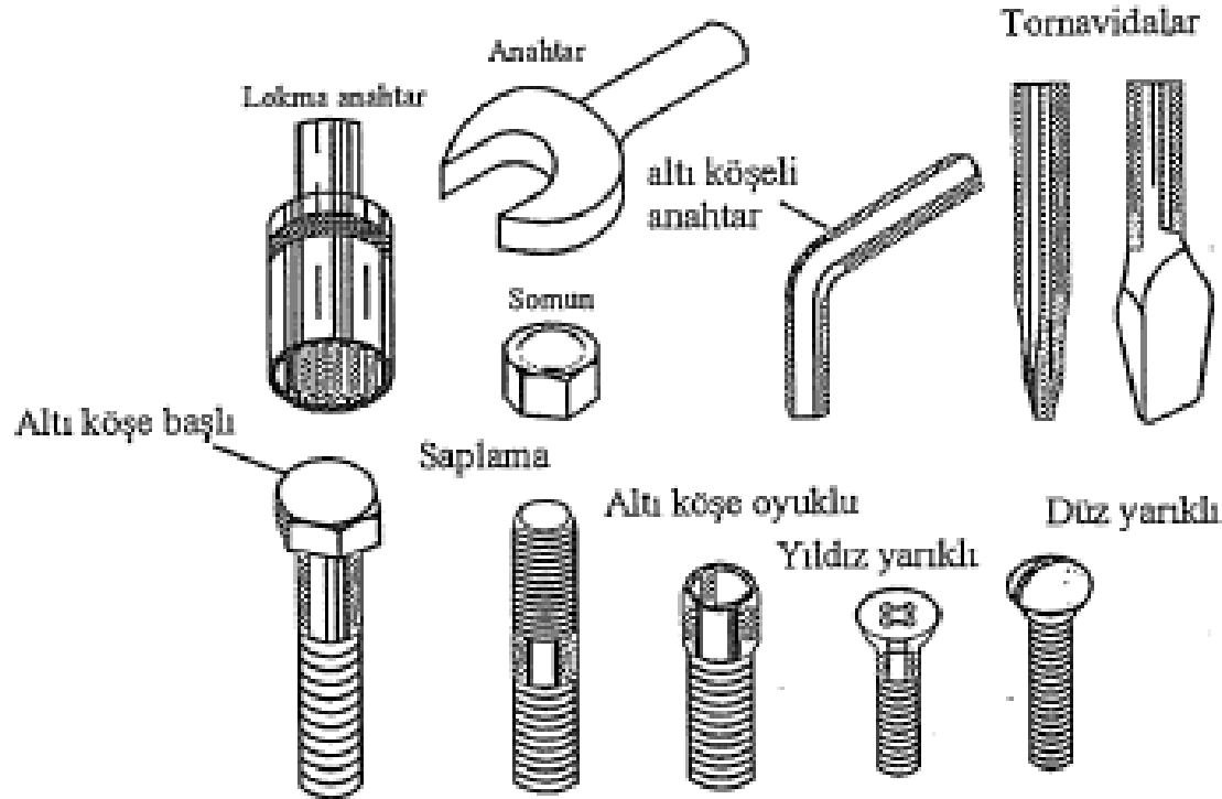
Şekil 13.21 Cıvata ve somunların sıkılması
