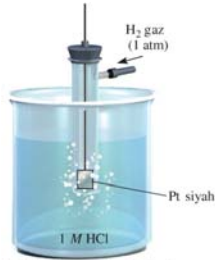
Şekil 21-8 Standart hidrojen elektrot (SHE). Şekil 21-10'da bir anot olarak ve Şekil 21-9'da bir katot olarak gösterilen SHE'un moleküler düzeyde çalışmasının görünümü.
