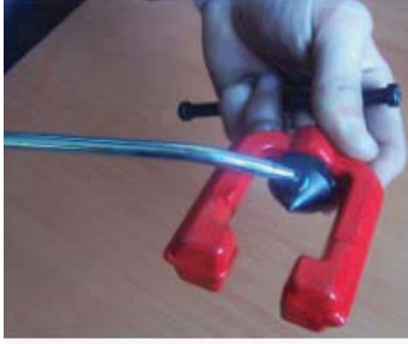
Resim 4.3 : Havşa konisinin yağlanması
