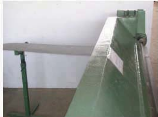
Resim 3.8: Uzun parçaların tekniğe uygun bükülmesi
