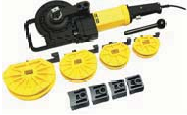
Resim 4.4: Bakır boru bükme makinesi
