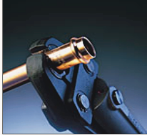
Resim3.2: Fittings boru kollu pres makinesiyle preslenir.
