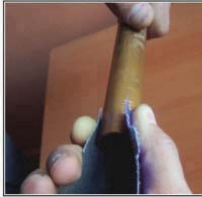
Resim 2.6 : Zımpara ile boru yüzeyindeki apak ve oksit tabakalarının temizlenmesi
