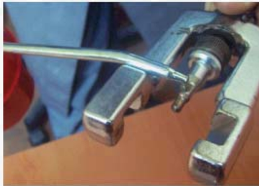
Resim 3.4 : Havřa takımında zımbanın yağılanması
