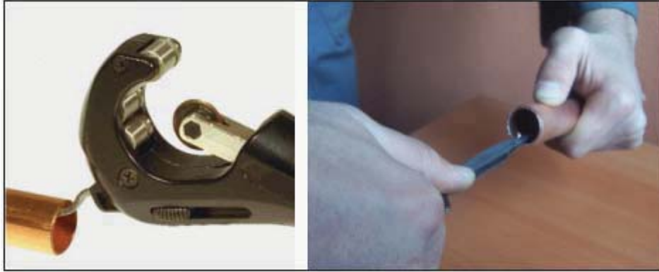
Resim 2.5 : Boru keskisi raybası ve akı ile apak alınması
