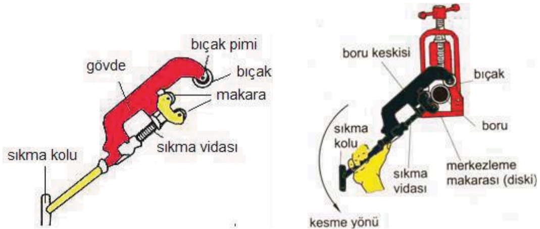
Şekil 2. 4: Metal boru keskisi kısımları ve kesme yönü
