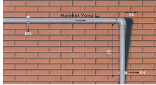
Resim 2. 2.1: Genleşme sonucu borunun hareketi
