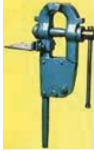
3. Demirci mengenesi (Kuyruklu mengene de denir. Darbeli çalışma gerektiren parçaların işlenmesinde kullanılır.)
