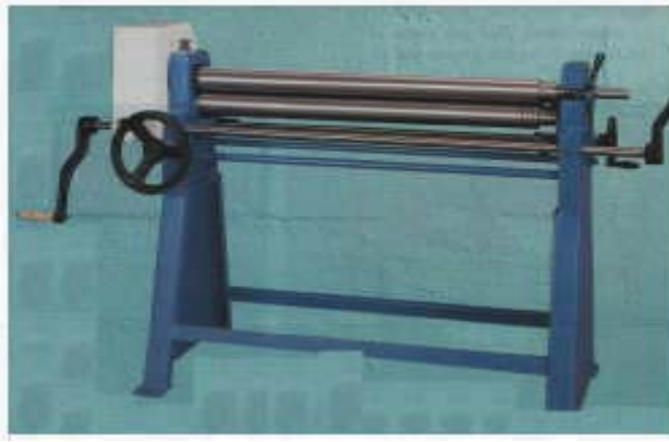
Resim 3.11: Sac ve yassı gereçlerin büküldüğü silindir makineleri
