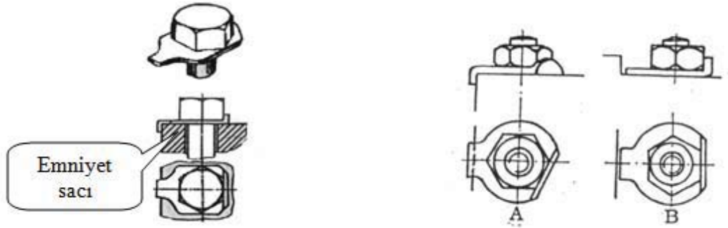
Şekil 1.23: Somunların kısmi frenlenmesinde kullanılan rondelalar
