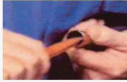
Resim2.4: Raybayla kesilen borunun iç çapağı ve dış çapağı alınır
