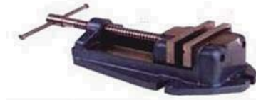
2. Tezgâh mengenesi (Freze, matkap, vargel gibi tezgâh tipi makinelerde işlenecek parçayı bağlamak için kullanılır.)
