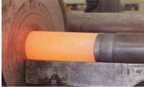
Resim1.1: Bakır borunun haddede çekimi
