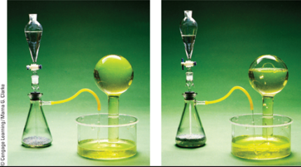
Şekil 12-6 Dalton kanununun gösterimi. Aynı basınçta aynı kapta A ve B gazları karıştırıldığında, kısmi basınçlarının toplamına eşit bir toplam basınç uygulanır.
