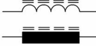
Resim 3.4: Ferit nüveli bobin sembolü
