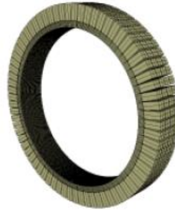
Blok dedektörler yan yana halka şeklinde yerleştirilmesi (Halka dedektörler)
