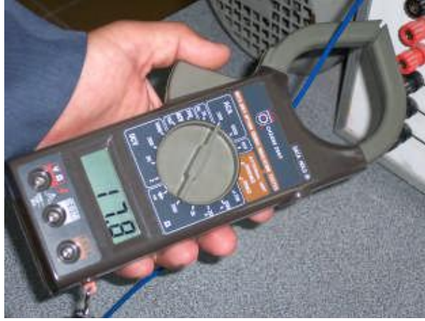
Pens ampermetre ile akım ölçmek
