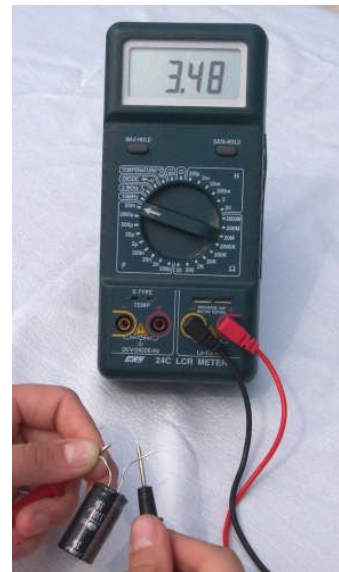
Avometre ve LCR metre ile kapasite ölçümü
