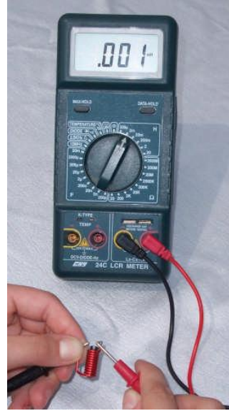
Avometre ve LCR metre ile endüktans ölçme
