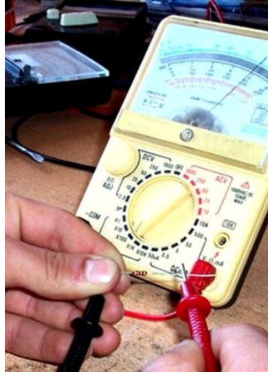
Avometre ile direnç ölçümü
