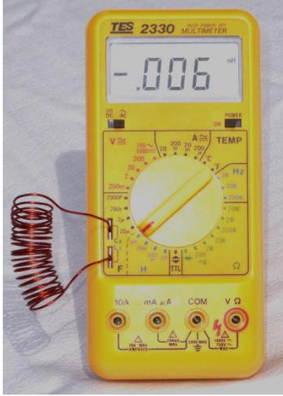
Avometre ve LCR metre ile endüktans ölçme
