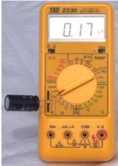
Avometre ve LCR metre ile kapasite ölçümü
