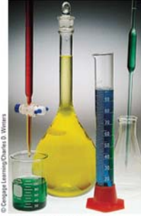
Şekil 1-18 Sıvıların hacmini ölçmede kullanılan bazı laboratuvar aletleri: 150-mL beher (sol alt, yeşil sıvı); 25-mL büret (sol üst, kırmızı); 1000-mL balon joje (ortada, sarı); 100-mL dereceli silindirik (sağ ön, mavi); 10-mL pipet (sağ arka, yeşil).
